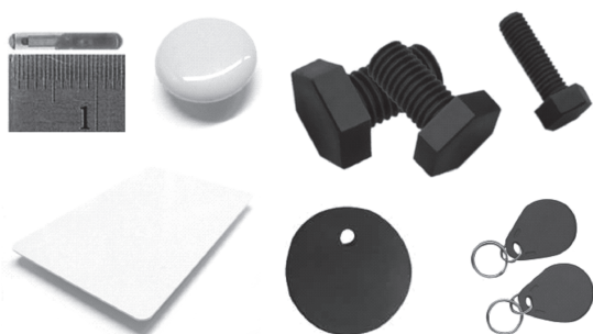
Figura 3.2. Tags RFID pasivos con diferentes formas y características.
